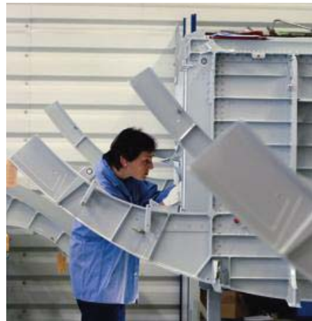
Assemblage de case de train d'atterrissage pour l'Airbus A320.
